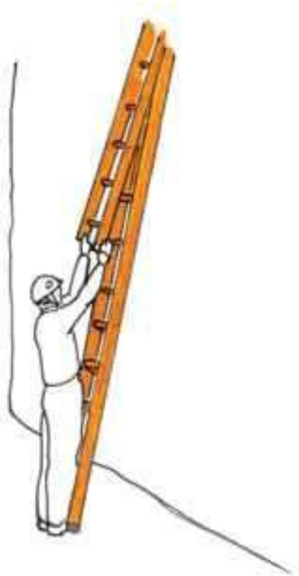
Fig. 38 - Modalità corretta di montaggio
