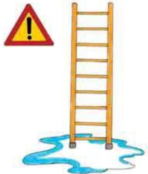
Fig. 24 - Appoggiare la scala su superfici non scivolose
