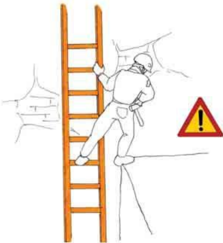
Fig. 43 - Non posizionare un piede su un gradino (piolo) e l'altro su un oggetto o ripiano.
