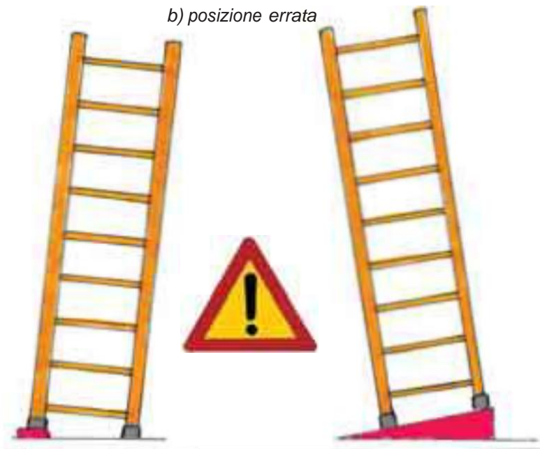
Fig. 25 - Superficie inclinata lateralmente. Appoggiare la scala solo su superficie orizzontale
