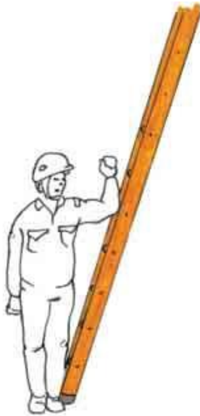
Fig. 30 - Un modo approssimato di verifica della corretta inclinazione della scala in appoggio
