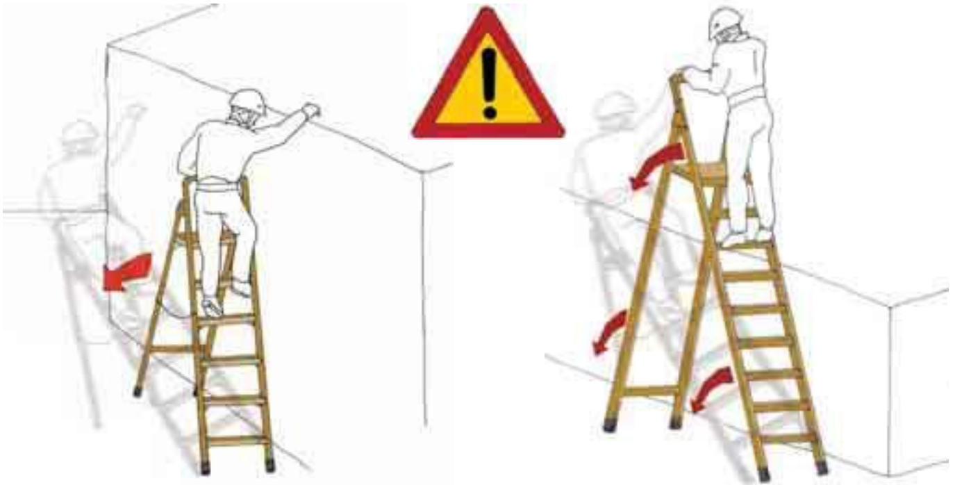
Fig. 4 - Erroneo uso della scala: posizione laterale e sistema di accesso ad altro luogo
