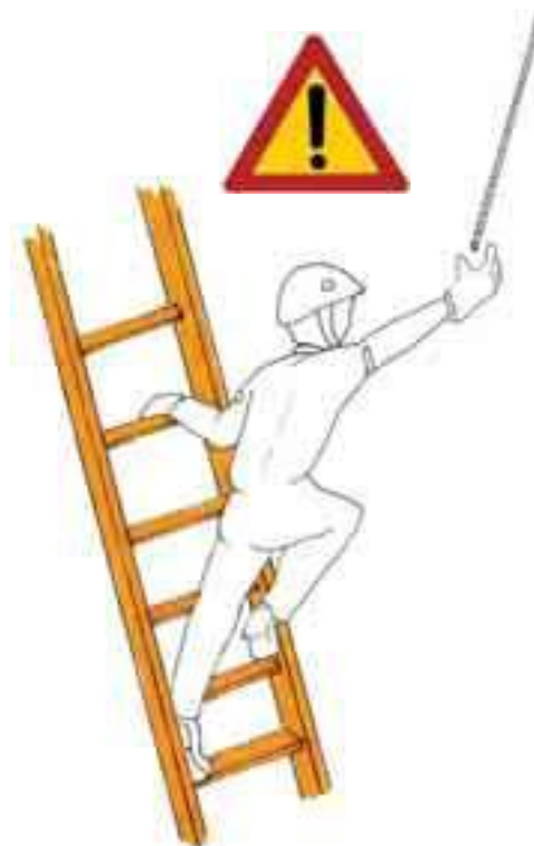
Fig. 42 - Posizionare entrambi i piedi sulla scala. Non sbilanciarsi
