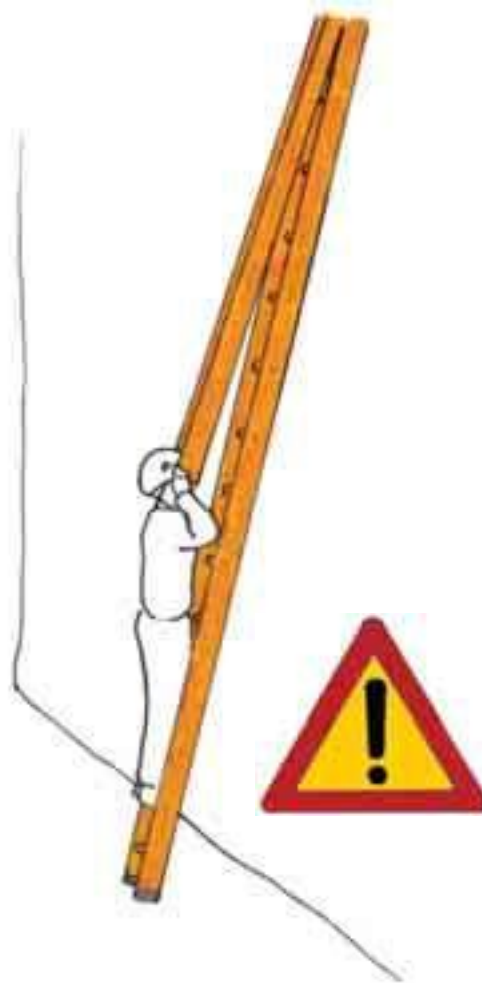
Fig. 39 - Modalità errata di montaggio
